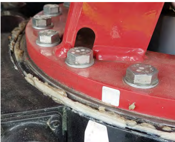
Figur 5.4 Überschüssiges Fett an der Stelle lassen.
