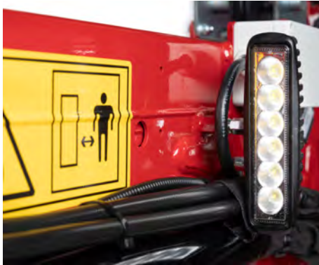
Figur 2.12 Zwei Arbeitsleuchten am Kran.
