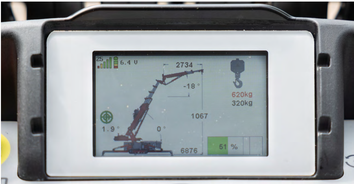
Figuur 2.9 Beispiel für die Anzeige auf der Fernbedienung
