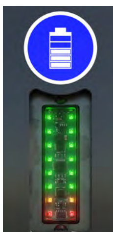
Figur 5.5 Batterieanzeige mit Ladezustand SOC (links) und Lademodus M (rechts)
