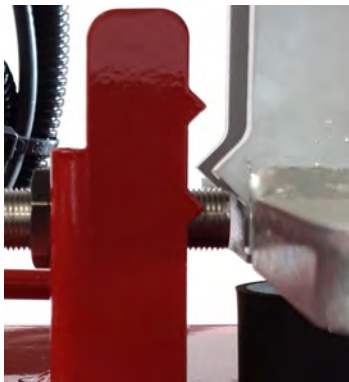
Figuur 4.7 Ölstand des Windenzylinders
