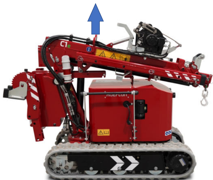
Abbildung 7.3 Kran für den Transport heben
