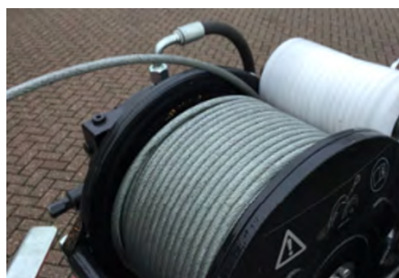
Figur 4.13 Câble serré sur le tambour
