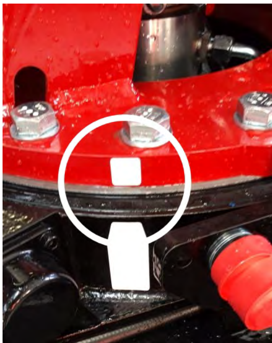
Figur 7.2 Midtposition af kranens søjle
