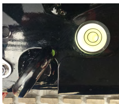
Figur 4.7 Nivellering af kranen
