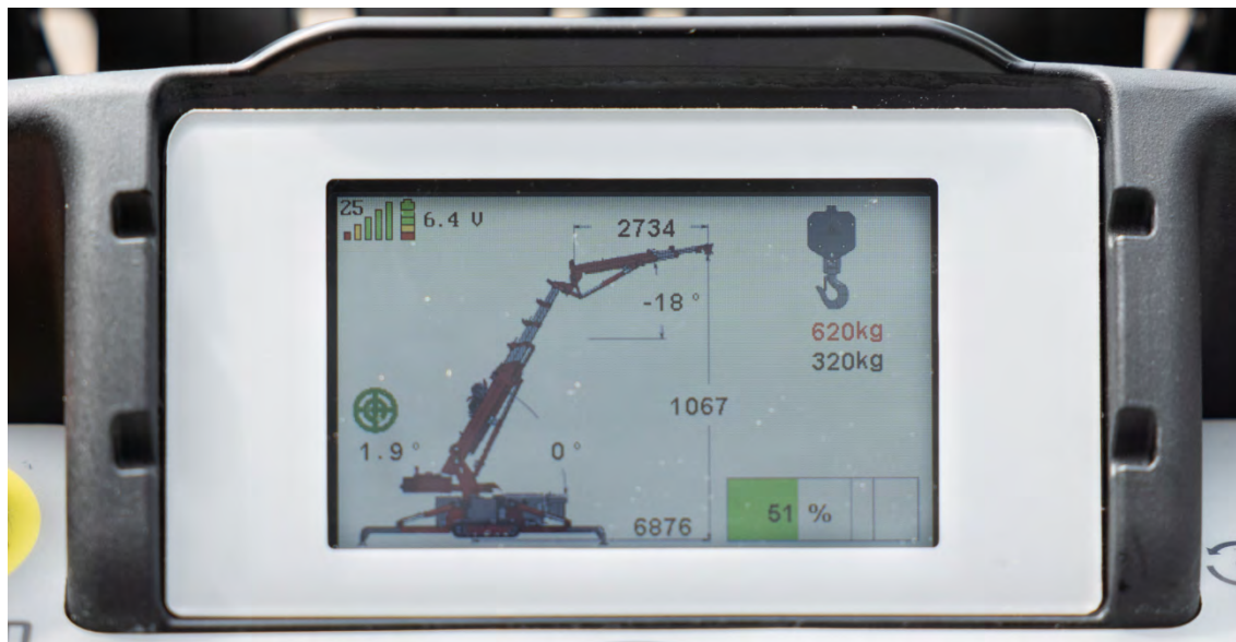
Figur 2.4 Eksempel på displayet på fjernbetjeningen
