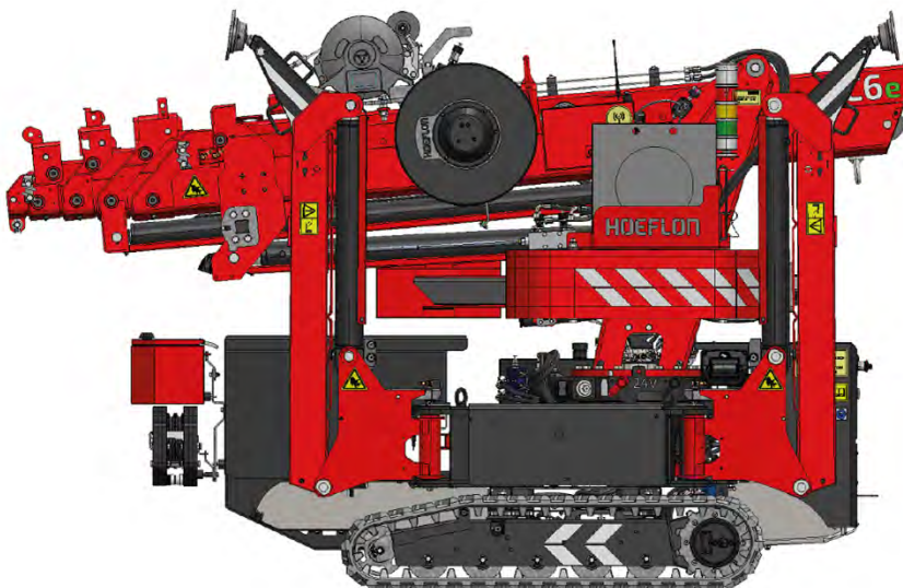
Figur 7.1 Kran i transportposisjon
