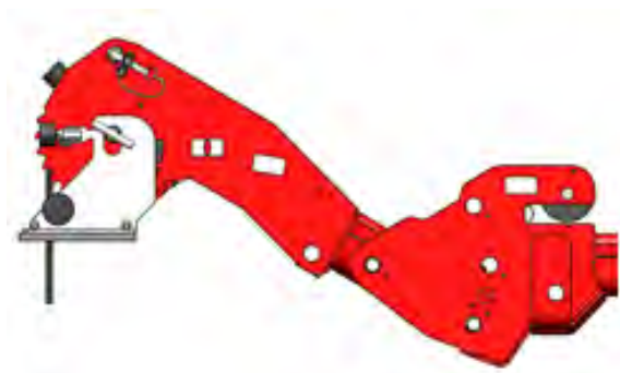
Figur 4.10 Justerbar seksjon, øvre grense
