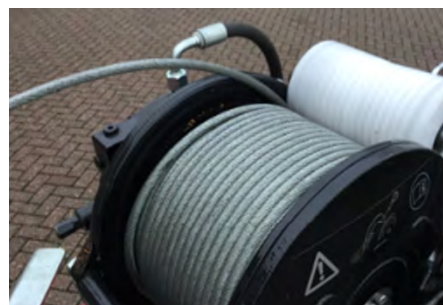
Figur 4.13 Kabel stram på trommelen
