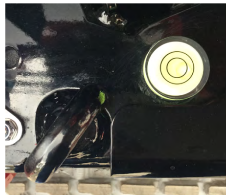
Figuur 4.7 Levelling the crane
