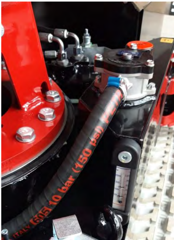
Figura 4.1 Controllare il livello dell'olio
