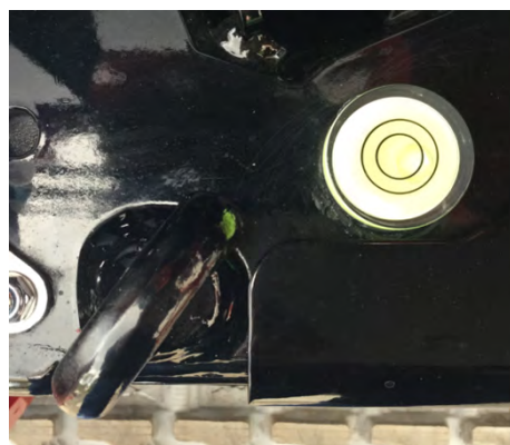
Figuur 4.7 Nivåställande av kranen
