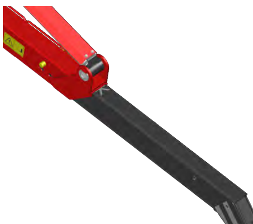
Figuur 4.6 Frigöra en utskjutbar stödbenssektion
