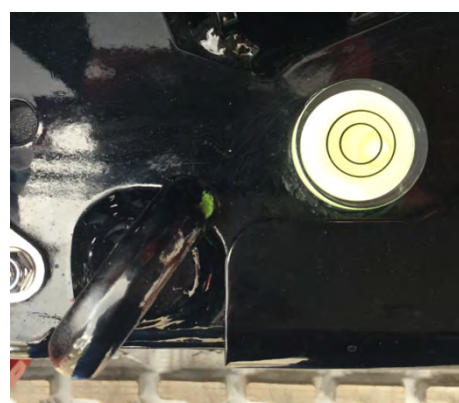
Figuur 4.7 Nivellere kranen
