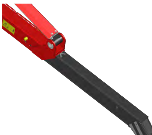
Figuur 4.6 Frigjøre uttrekkbar støttebenseksjon
