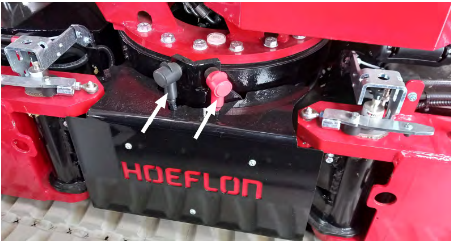
Figura 5.6 Puntos de carga de emergencia
