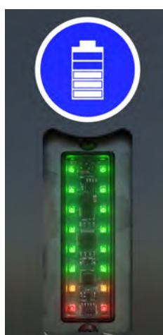
Figura 5.5 Indicador de batería con el estado de carga SOC (a la izquierda) y el modo de carga M (derecha)
