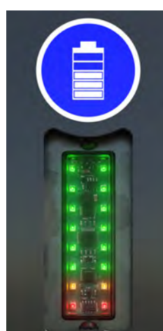
Figur 5.5 Indicateur de batterie avec état de charge SOC (à gauche) et mode de charge M (à droite)
