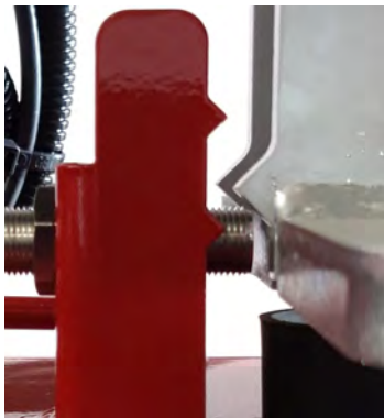
Figur 4.7 Vérifiez le niveau du cylindre du treuil
