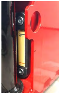
Figure 4.1 Vérifier le niveau d'huile
