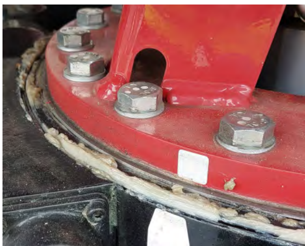
Figure 5.4 Laisser l'excès de graisse
