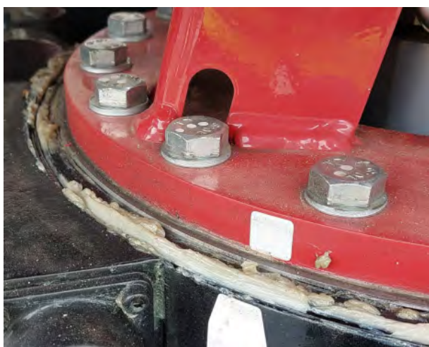
Figura 5.4 Lasciare in posizione il grasso in eccesso
