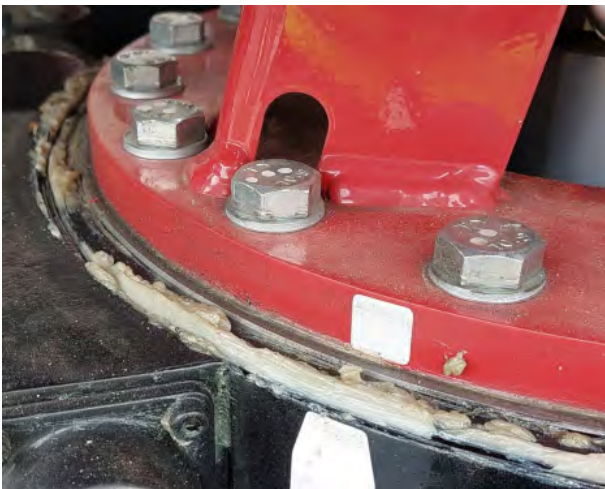
Figur 5.4 Låt överskottsfett sitta kvar
