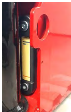
Figuur 4.1 Kontroll av oljenivån
