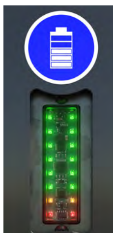
Figur 5.5 Batteriindikator med laddningsstatus (SOC, vänster) och laddläge (M, höger).
