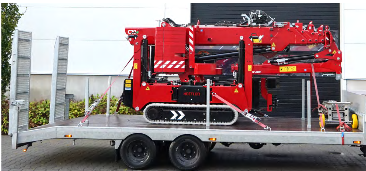
Figuur 7.2 Zabezpieczenie dźwigu
