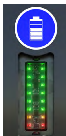
Figur 5.5 Wskaźnik akumulatora ze stanem naładowania (SOC, po lewej) i trybem ładowania (M, po prawej).
