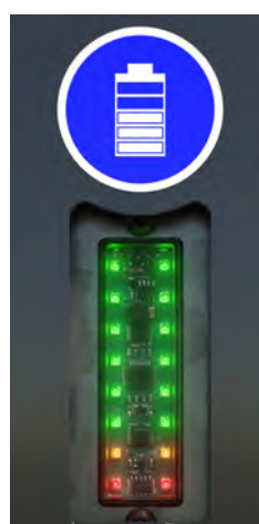
Figuur 5.5 Akun merkkivalo, jossa näkyy varaustila (SOC, vasen) ja lataustila (M, oikea).
