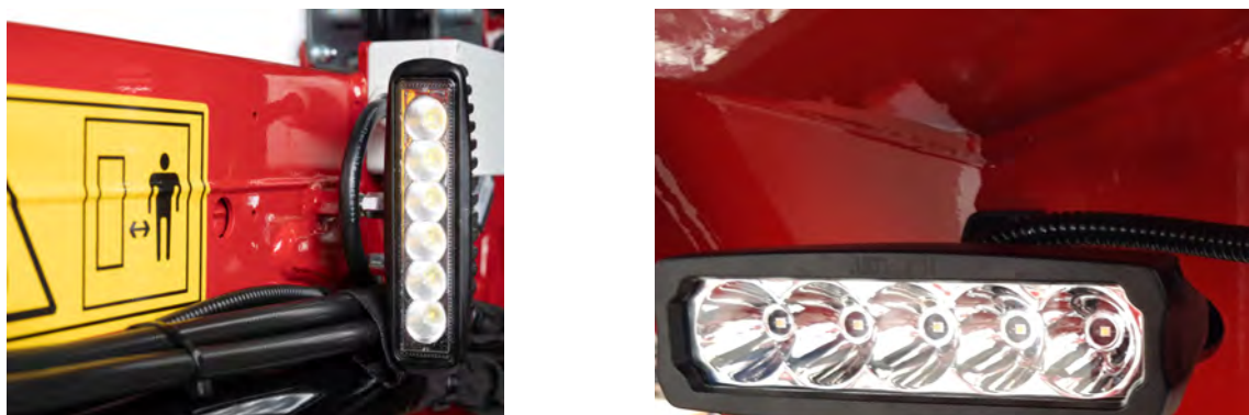
Figur 2.12 To arbejdslys på kranen
