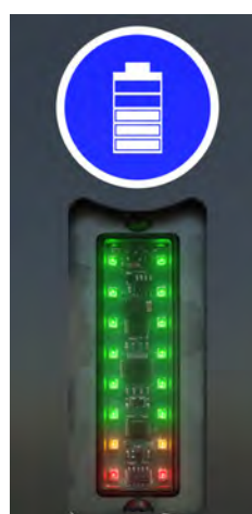
Figur 5.5 Batteriindikator med opladningstilstand (SOC, venstre) og opladningsfunktion (M, højre).
