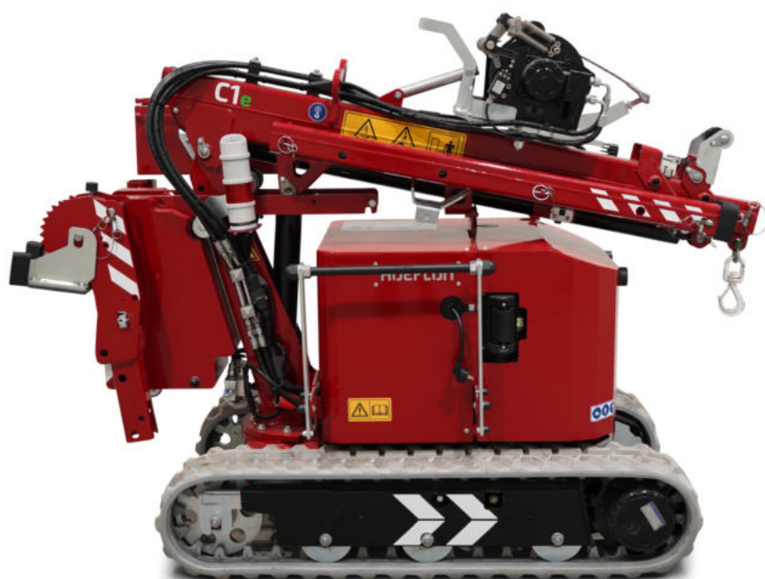
Figur 7.1 Kran i transportposisjon
