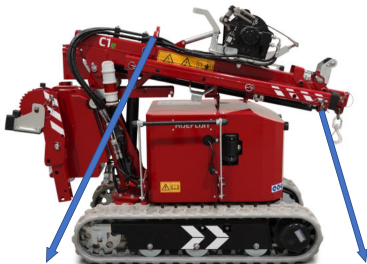
7.2 ábra A daru rögzítése
