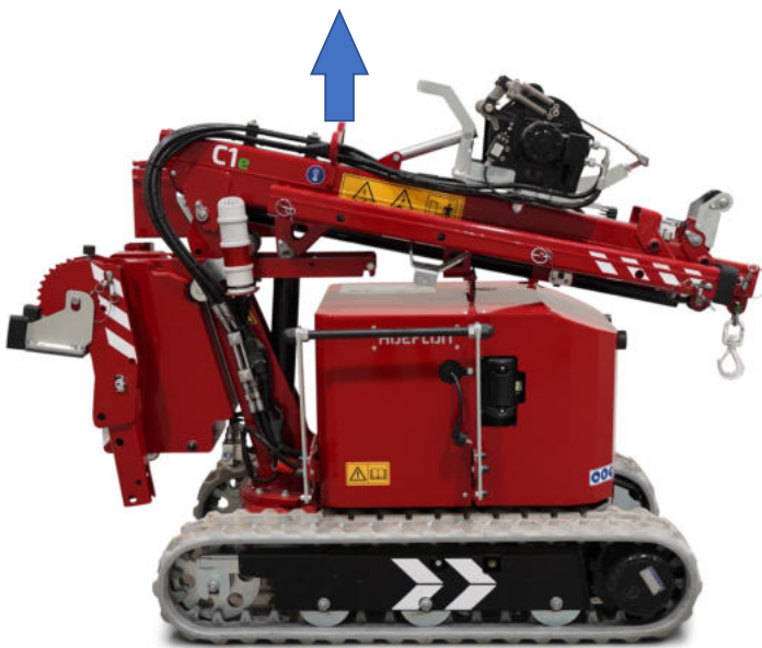
Figur 7.3 Nosturin nostaminen kuljetusta varten
