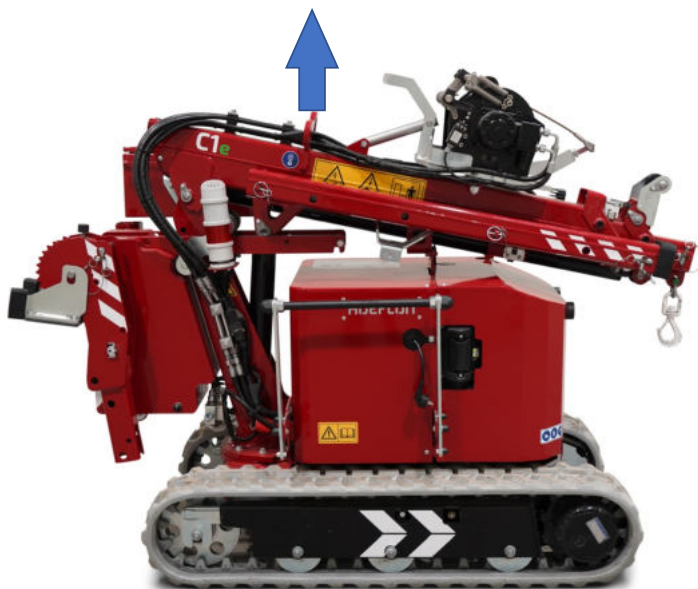
Figure 7.3 Surélever la grue pour le transport
