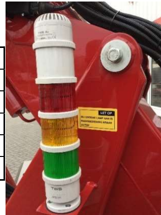
Figura 7: torre de señales
