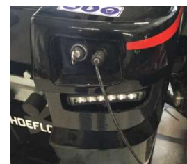
Ilustracja 9: Układ sterowania awaryjnego
