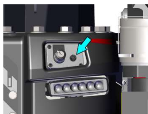
Ilustracja 8: Układ sterowania awaryjnego
