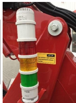
Figura 9: torre de señales
