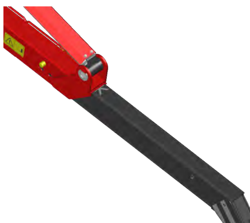
Figuur 4.6 Uitschuifbaar gedeelte stempelpoot
