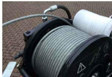
Figuur 4.13 Kabel strak op de trommel
