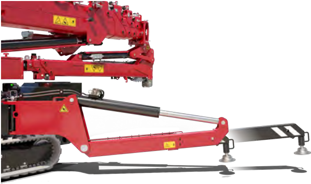
Figuur 2.4 Handmatig uitschuifbare stempelpoten
