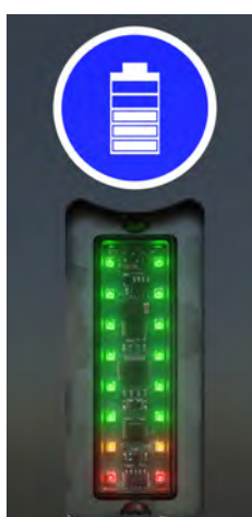
Figuur 5.5 Accu-indicator met de laadstatus SOC (links) en de laadmodus M (rechts)
