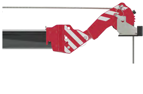
Bovenste positie van de lierkop in de afstelbare sectie (Positie 4)
