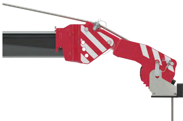
Verlaag de positie van de lierkop in de afstelbare sectie (Positie 1)
