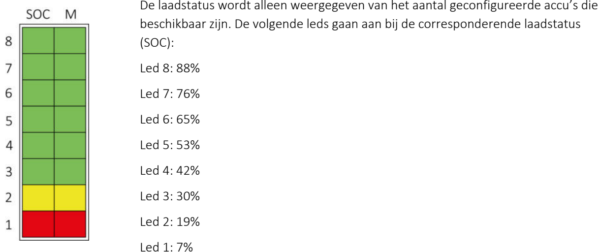
Figuur 5.4 Indicatiebalk met de laadstatus SOC (links) en de laadmodus M (rechts)
